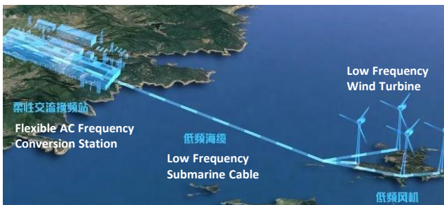
35\text{kV} 柔性低频输电 (20Hz) 工程
